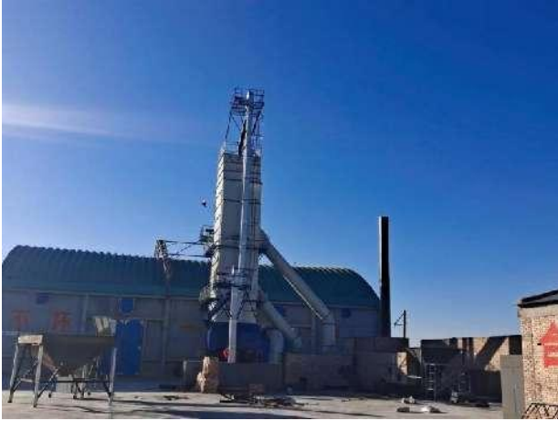
玉米烘干塔和水浴除尘设施
