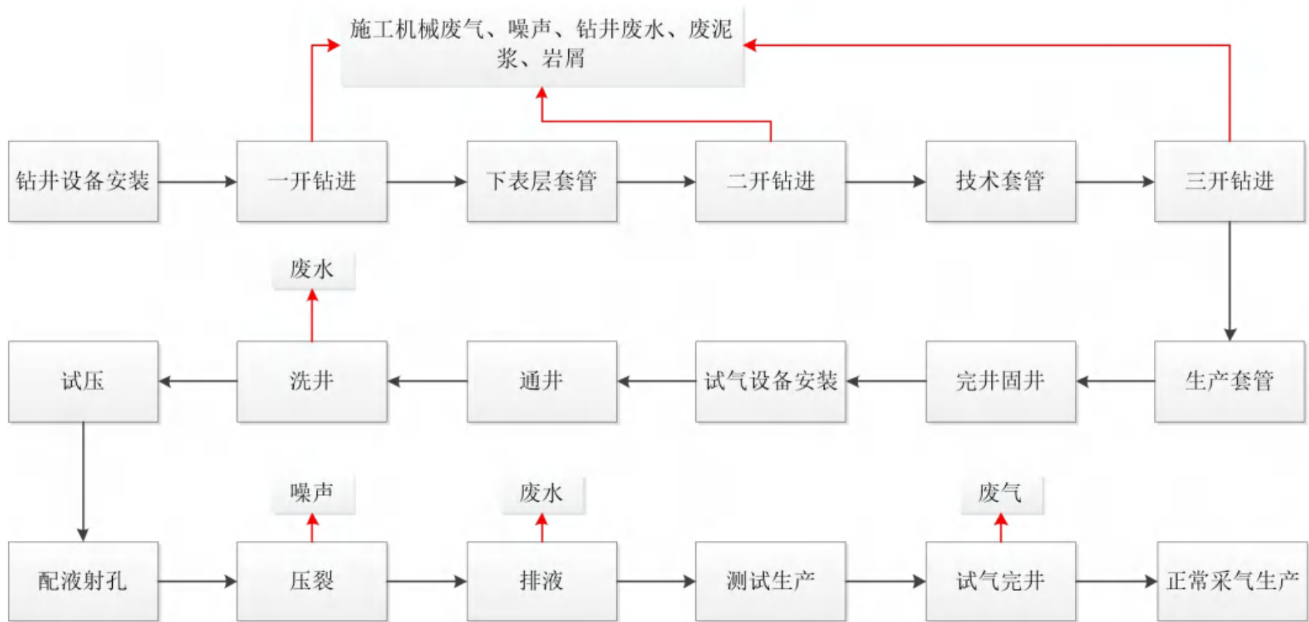
图 3.2.6-1 钻井作业工艺流程及产污环节图
