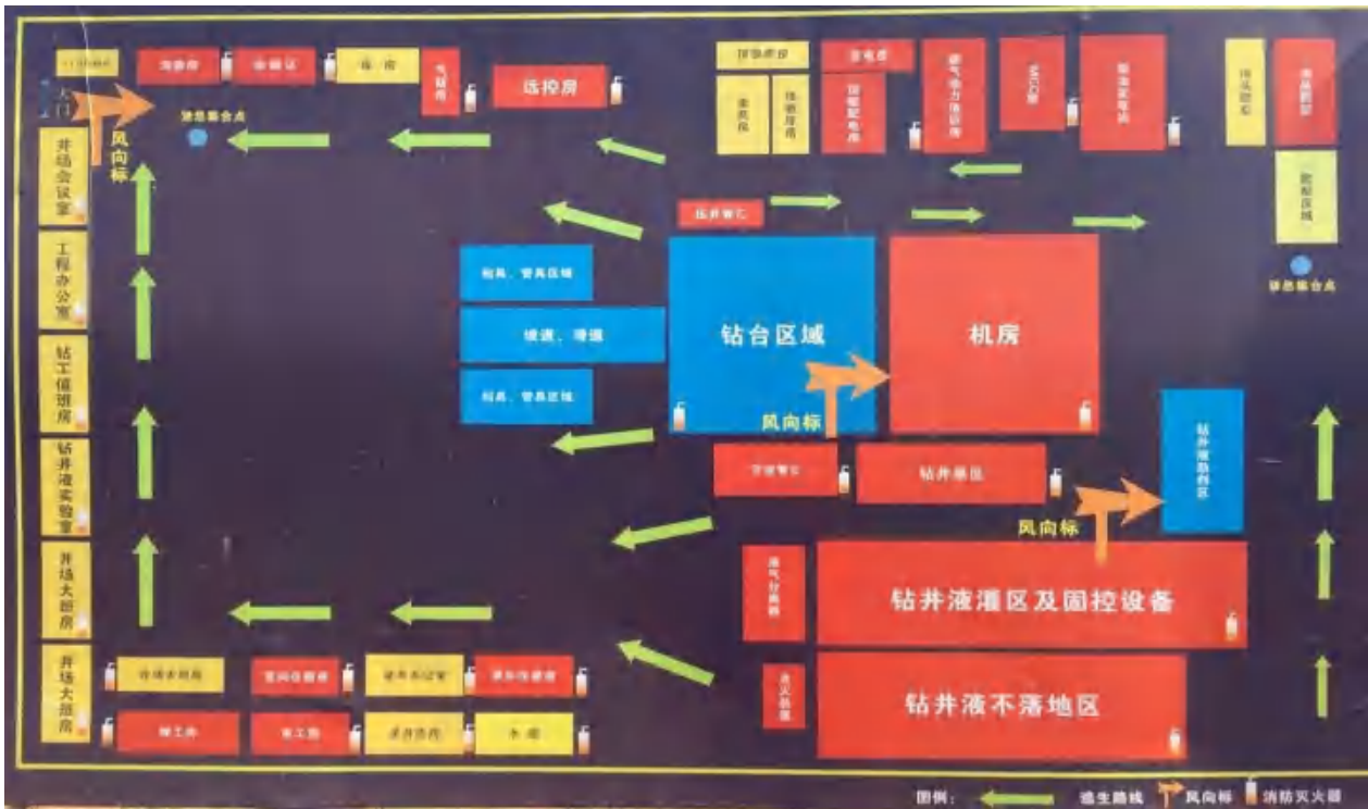
附图2 井场施工平面布置示意图
