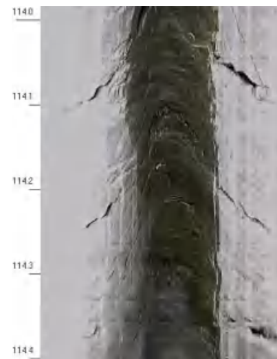
图8.3-15 114.04/85.22m深处横向裂隙
