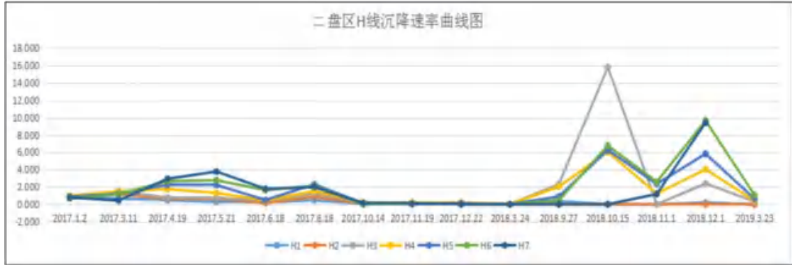
图7.1-6 23101工作面中H观测线岩移观测点沉降速率图
