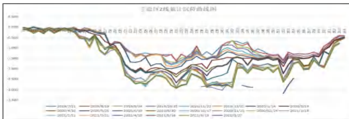
图7.2-1 33106/33107工作面中东西向Z线岩移观测点沉降曲线图
