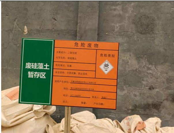
甲氨基危废暂存库危险废物标识
