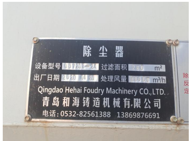
除尘器标识牌
