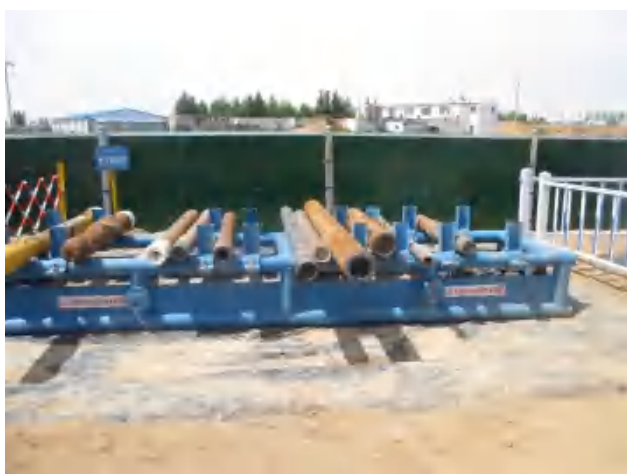
备用钻具预防落地油底部四周建立有效围堰，铺设防渗膜。
