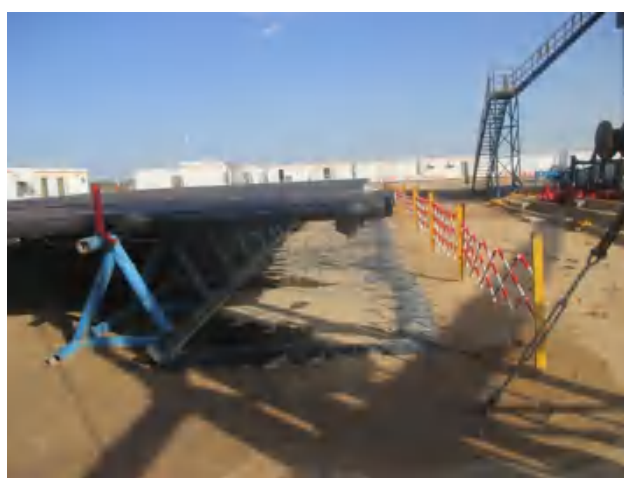
钻杆区钻杆两端底部四周建立有效围堰，铺好防渗膜。
