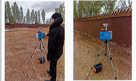
无组织废气现场采样图
