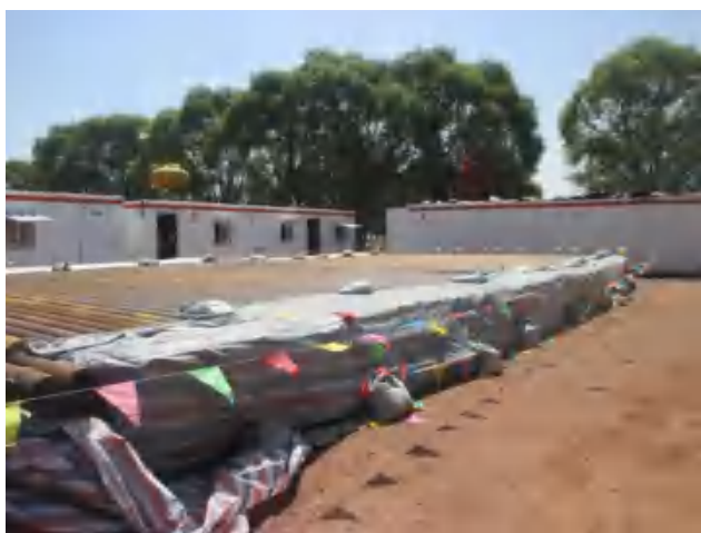
钻杆区四周建立有效围堰铺好防渗膜，钻杆两端进行包裹。
