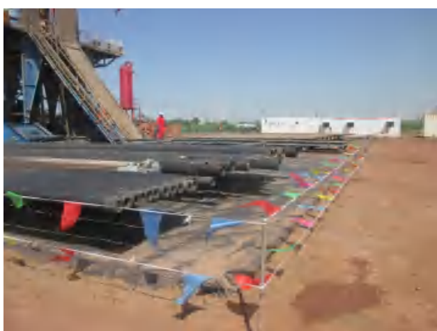
钻杆区钻杆两端底部四周建立有效围堰，铺设防渗膜。
