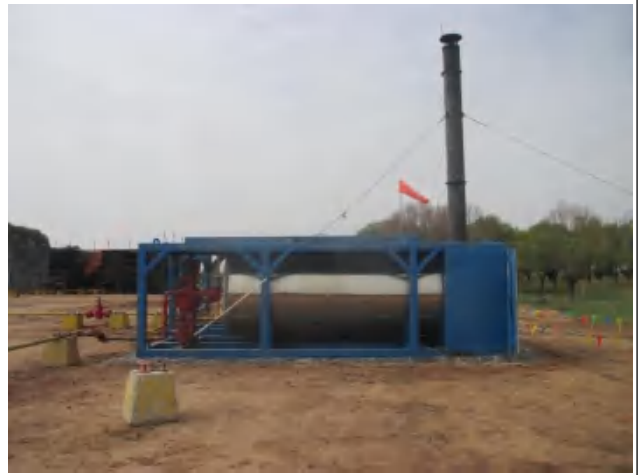
装置四周建立有效围堰铺防渗膜。
