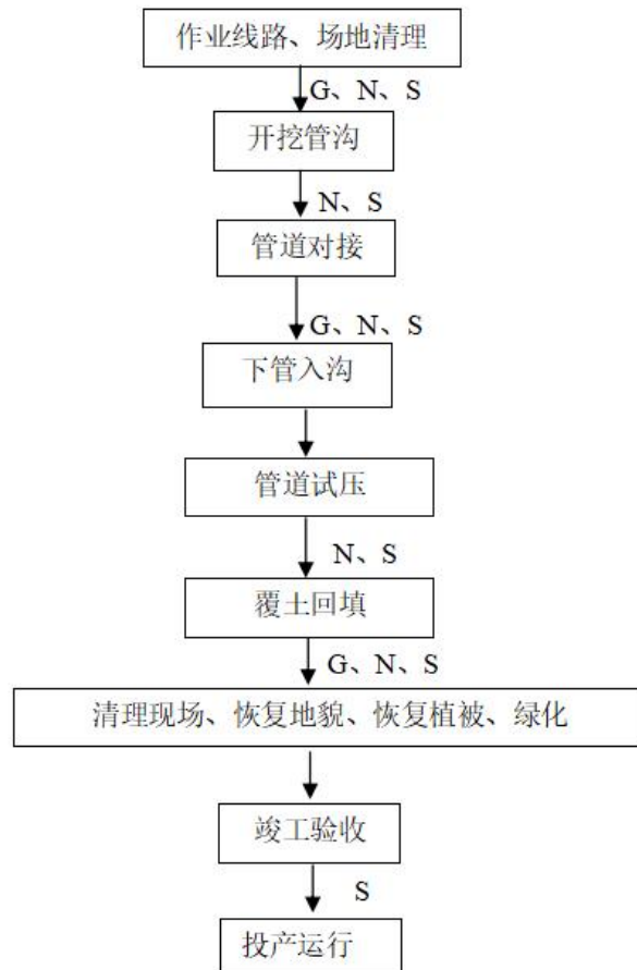
图 1.2-1 管线施工工艺流程
